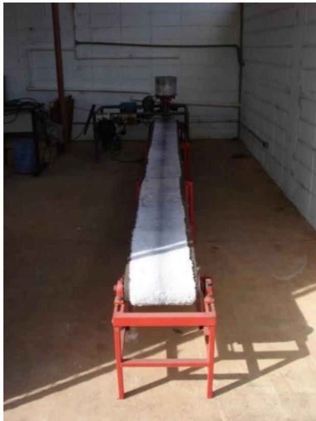
O dosador bem como o motor elétrico e redutor responsáveis por fornecer rotação ao sistema permaneciam fixos em uma bancada, posicionados na extremidade da esteira de borracha coberta com pelúcia medindo 4,20 m de comprimento por 0,30 m de largura, acionada por outro motor elétrico de 0,55 KW que fornecia uma rotação fixa que simulava uma velocidade de semeadura de cinco quilômetros por hora 5 km/h equivalente a 1,39m/s.
